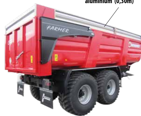
Rehausses à grains en aluminium (0,30m)
