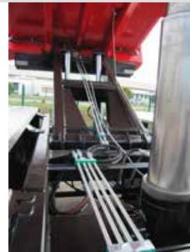
Trappes à grains en inox équipées de levier à manœuvre du sol Hauteur 2,40 m (en fonction des pneumatiques)
