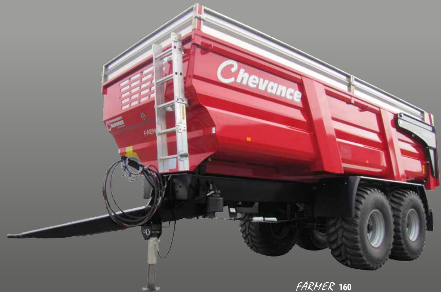
Trappes à grains en inox équipées de levier à manœuvre du sol Hauteur 2,40 m (en fonction des pneumatiques)
