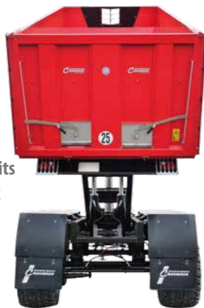
Trappes à grains en inox équipées de levier à manœuvre du sol Hauteur 2,40 m (en fonction des pneumatiques)
