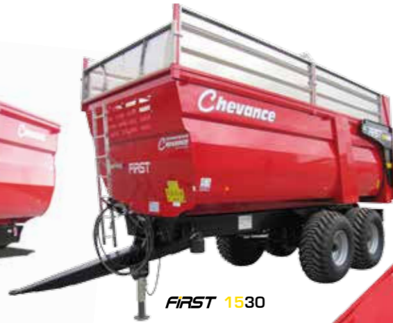
Réhausses à ensilage en aluminium
