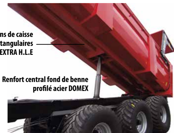
Angle à 135° pour éviter le dépôt et résidus
