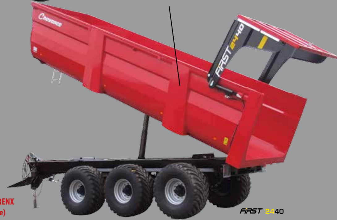
Montants assurant résistance et solidité
